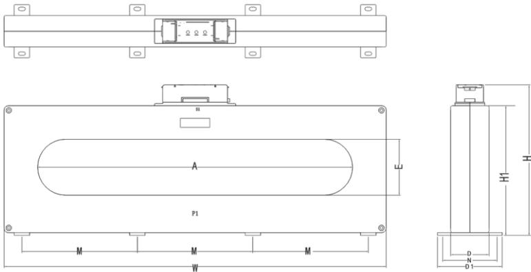
图 5 探测器外形示意图（配 DH-GST-N2100-F-2000 剩余互感器）
