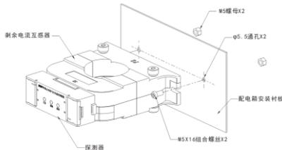
图 12 探测器安装过程分解图（配圆形开口式剩余电流互感器）
