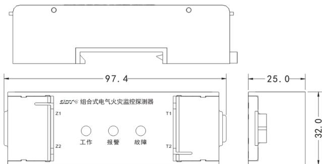
图 1 探测器信号处理单元外形示意图
