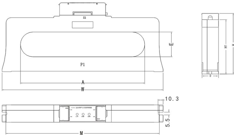
图 3 探测器外形示意图（配闭口式方孔剩余电流互感器）
