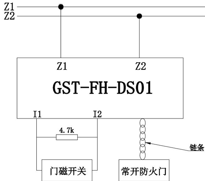
图 2-23 模块接线示意图
